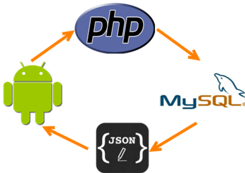
Εικόνα 24: Επικοινωνία Android και βάσης δεδομένων μέσω JSON/PHP
