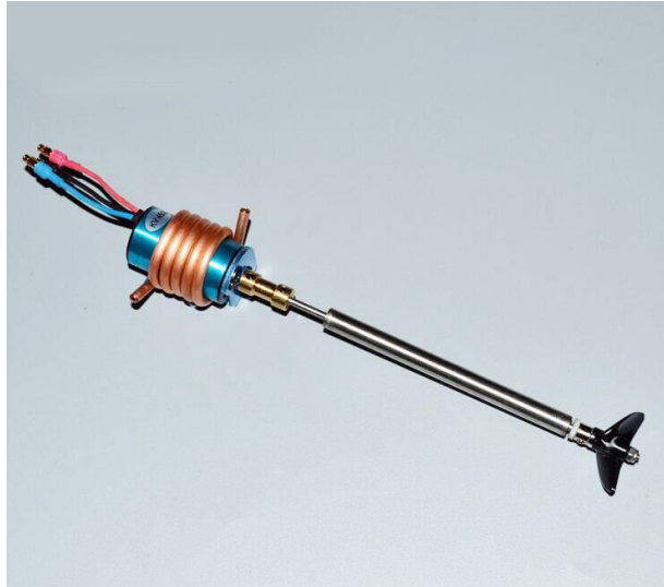
Εικόνα 2.5 Ηλεκτροκινητήρας σε σύνδεση με μεταλλικό σύνδεσμο και τον άξονα προπέλας
