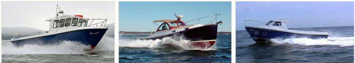
Εικόνα 2.2 Σκάφη τα οποία ανήκουν στην κατηγορία γάστρα ημικτοπίσματος
