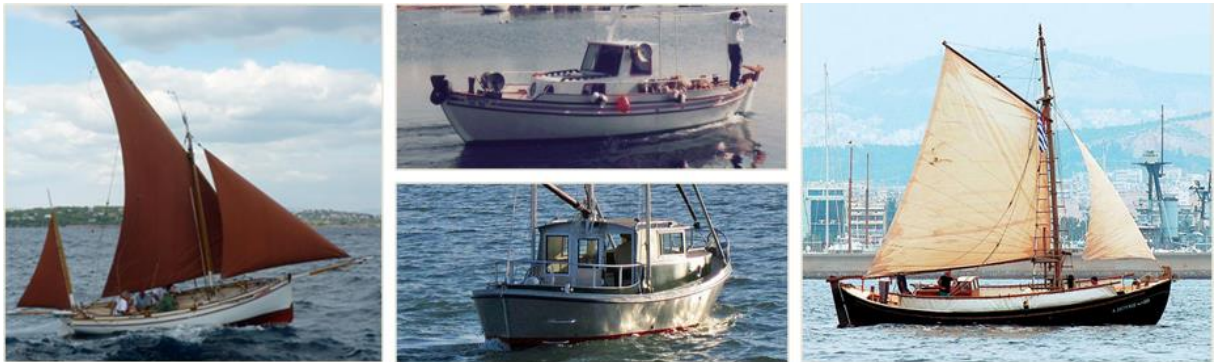
Εικόνα 2.1 Σκάφη τα οποία ανήκουν στην κατηγορία γάστρα εκτοπίσματος
