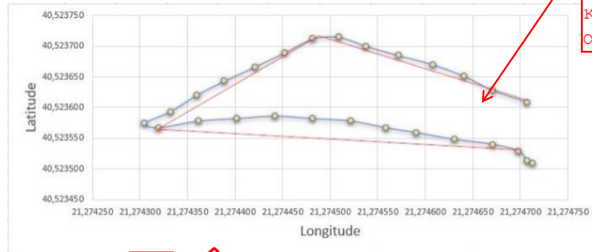
Εικόνα 5.6 Καταγεγραμμένες τοποθεσίες του σκάφους κατά την διάρκεια αυτόνομης πλεύσης σε σύγκριση με την επιθυμητή πορεία στην τρίτη δοκιμή
