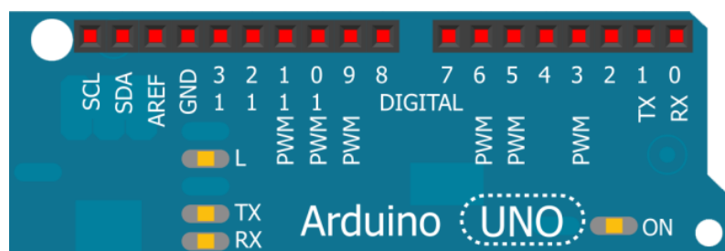
Εικόνα 5: Οι ψηφιακοί ακροδέκτες του Arduino.
