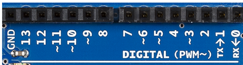
Σχήμα Β΄.3: Οι ψηφιακοί ακροδέκτες του Arduino UNO.
