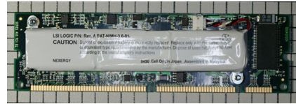
Σχήμα 3.3: Μνήμη DRAM με ενσωματωμένη μπαταρία.
