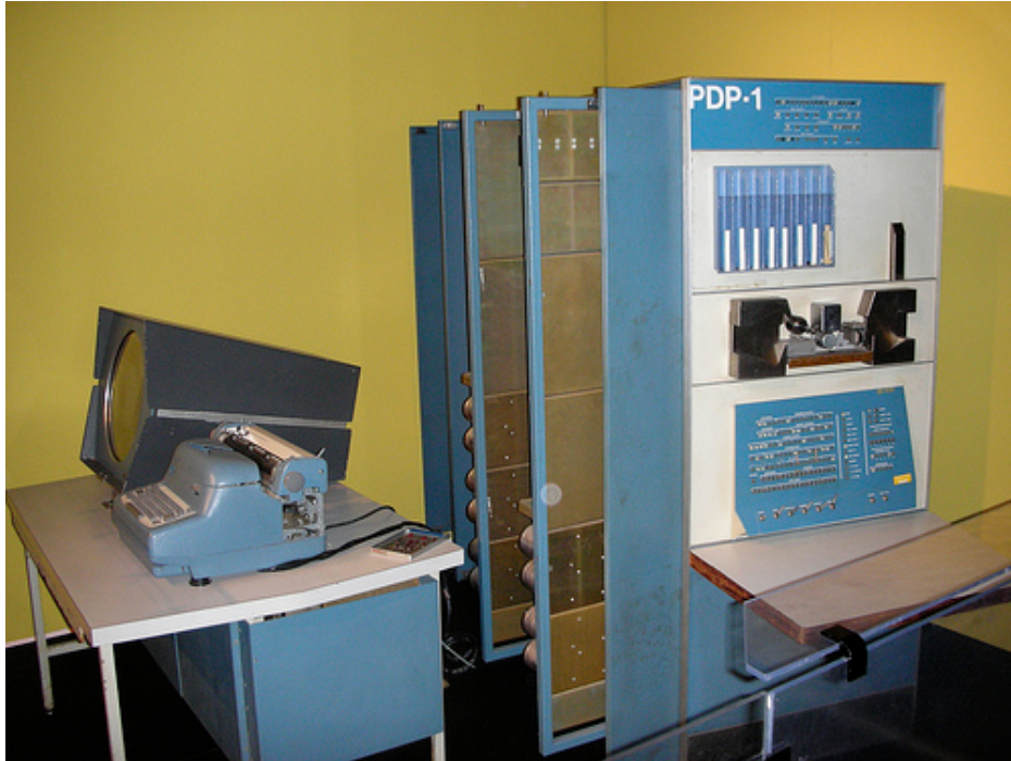
Σχήμα 1.5: Ο πρώτος εμπορικός υπολογιστής ήταν ο PDP-1 της DEC, που υποστήριζε πλήθος επιπρόσθετων περιφερειακών. Εικόνα από www.boerner.net .
